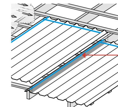
При монтаже на уклоне крыши 5-15° в местах горизонтального и вертикального нахлестов по линии точек крепления обязательное использование ленты ОНДУТИС ВЛ.
