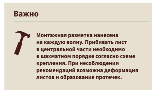
Если обрешетка сделана таким образом, что отметки для гвоздей не попадают на доски обрешетки, допускается устройство кровли с соблюдением следующих требований:
